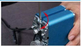
用手压下皮带,皮带压下量为3至5mm时皮带松紧度适宜,然后拧紧电机固定块上的两颗螺丝后把皮带轮罩安装上即可。
