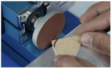
打磨凿刀的时候,右手抓住凿刀手柄,左手扶住凿刀,让凿刀靠近砂轮,让凿 刀的刀刃逆着砂轮转动的方向打磨凿刀(如图)。
