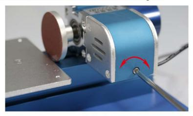
用手压下皮带,皮带压下量为3至5mm时皮带松紧度适宜。
