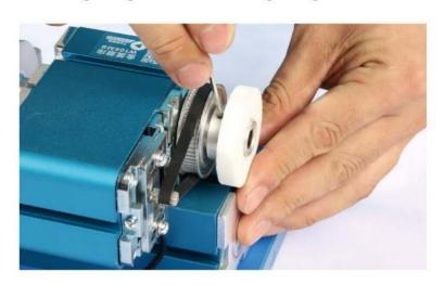
在主轴箱底部放入单孔槽,并把砂轮罩放入。 Place the slot nut and protection cap.
