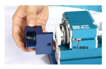
使用十字盘头螺钉 M4X10 锁紧皮带轮罩。 Lock the protection cap with screw.
