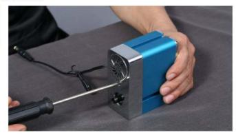
松开固定块上 两个螺丝 Loosen the screw
