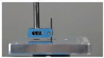
当进行锯割进给时,应沿着锯齿方向用力,给予平行于锯齿方向的力度,切割带弧度的形状时,以锯条为圆心旋转材料。
